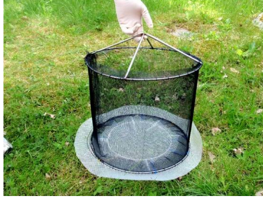
Figur 6. Rekryteringskorg för undersökning av yngeltäthet, i hoppfällt skick till vänster och i samband med att korgen lyfts till höger.
