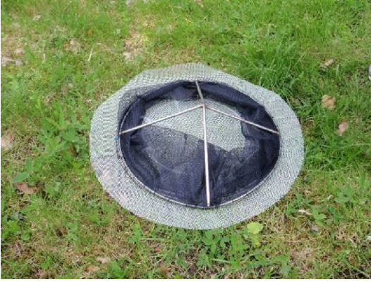
Figur 6. Rekryteringskorg för undersökning av yngeltäthet, i hoppfällt skick till vänster och i samband med att korgen lyfts till höger.
